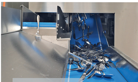
Transportband der neuen Bestecksortieranlage in der Mensa an der Universität Ulm
